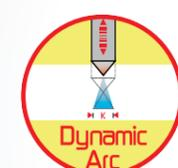
La fonction **DYNAMIC ARC** permet de maintenir constant le produit tension x intensité. Le générateur augmente l'intensité de soudage à mesure que la tension d'arc diminue et réduit la valeur du courant de soudage lorsque la tension d'arc augmente.
