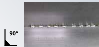
Soudage en angle de tôles d'épaisseur de 0,6 mm.
