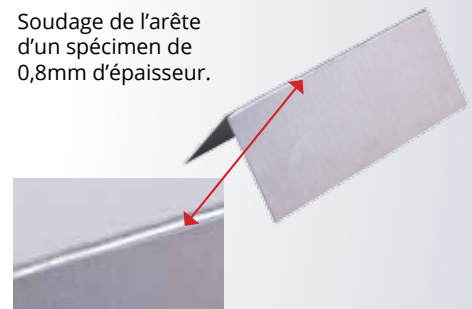
Détail du soudage d'arête. On remarque le niveau de finition et la précision du soudage obtenus.
