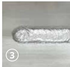
**NIVEAU 3:** Un courant réduit termine le soudage d'une manière optimale, en remplissant le cratère final sur le cordon.
