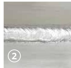
**NIVEAU 2:** On utilise le courant de soudage optimisé pour l'épaisseur et l'usinage exigés.
