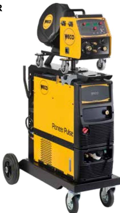
**Pioneer Pulse 403-503MSR** est un poste à souder professionnel à technologie onduleur triphasé avec chariot dévidoir séparé pour le soudage **MIG MAG Pulsé et Double Pulsé et Standard Synergique**. des aciers ordinaires et inoxydables ainsi que de l'aluminium.
