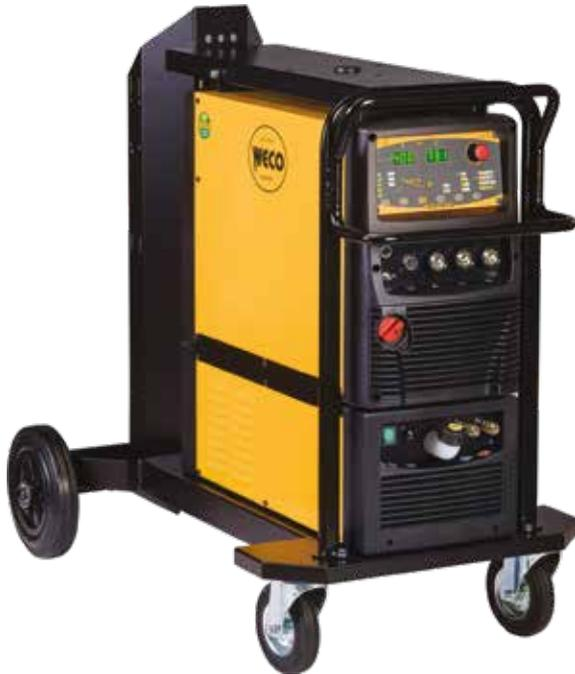
**Cruiser 502AC/DC** est un poste à souder de type onduleur, innovant et complet, avec d'excellentes caractéristiques de l'arc, idéal pour les soudages **TIG DC, AC et MMA**.
